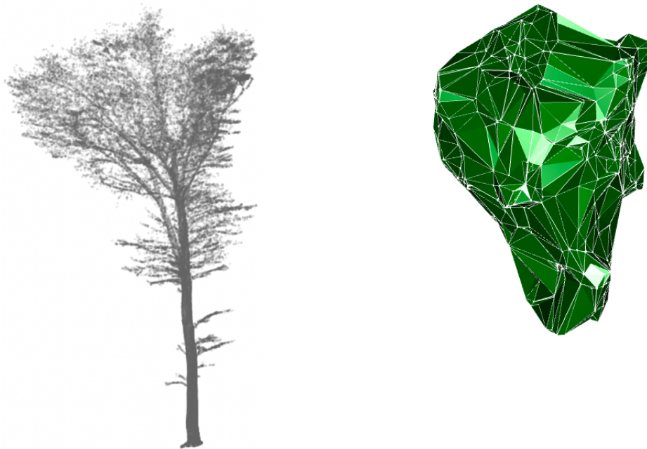
Fig 5. Scanarea 3D de înaltă precizie a unui arbore cu TLS în suprafețele de probă create (stânga), permite estimarea volumului convex a coroanei, reconstituită prin interpolări Delaunay (dreapta).
