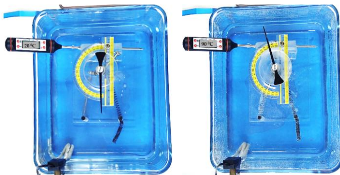
Figura IV.3. Deplasarea unghiulară a actuatorului unghiular la încălzire
