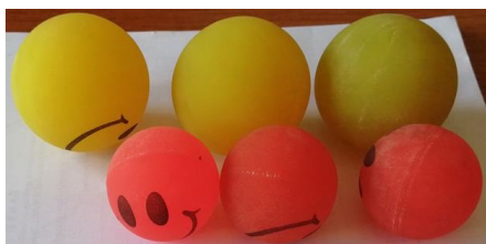
Figura VI. 1. Sfere din cauciuc, utilizate la experimente, de diametre \phi_1 = 42,35 mm și \phi_2 = 54,4 mm.
