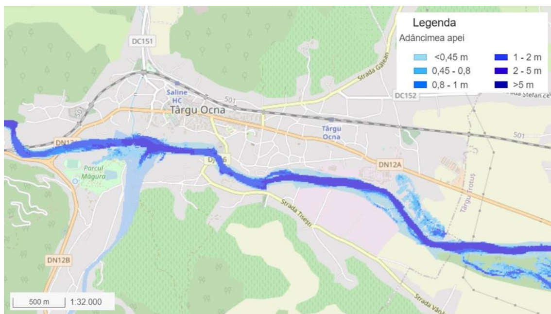
Figura 11. Harta riscului la inundații (10 %) pentru stațiunea Tg. Ocna, conform Directivei Inundații 2007/60/CE, Ciclul II
