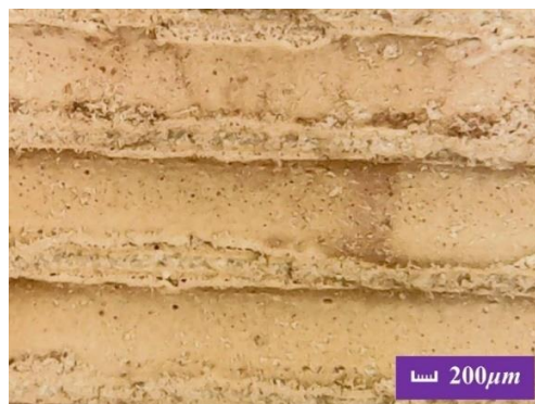
Fig. 5.15. Secțiune prin microcanalele fagurelui SCR, înainte experimentelor.
