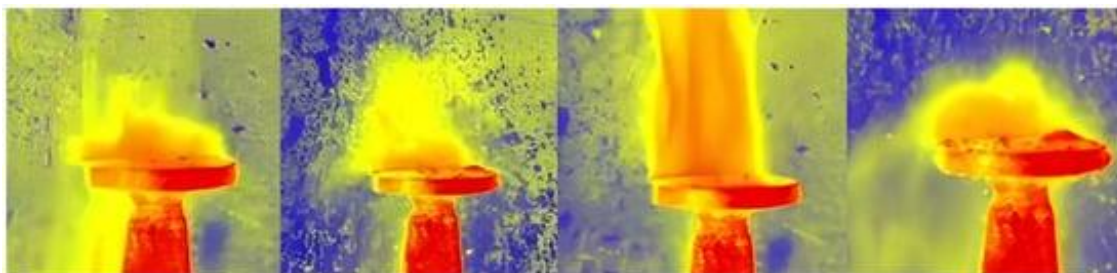
Fig. 5.24. Evoluția vaporilor picăturilor de AdBlue în prezența calefacției generate de ultrasunete de 20kHz.
