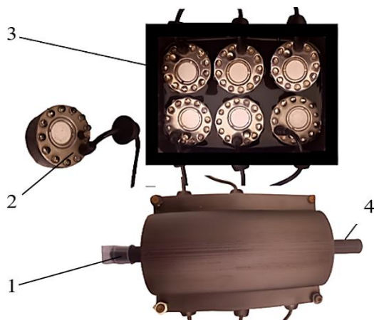
Fig. 4.9. Sistemului de generare a vaporilor de AdBlue.
