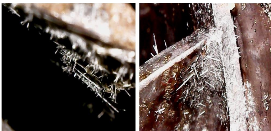
Fig. 5.9. Apariția incipientă a formațiunilor aciculare ale sărurilor de AdBlue, în zona tronsonului de injecție.
