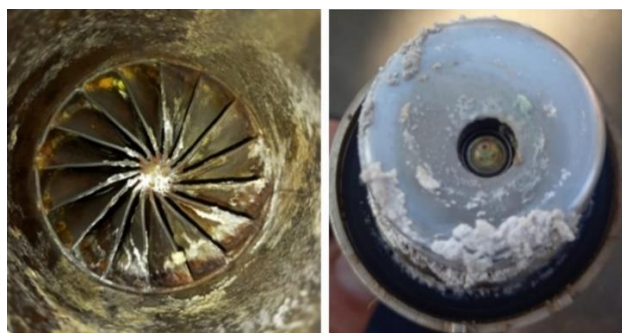
Fig. 5.12. Depuneri pe mixerul și injectorul SCR după un ciclu de încercări.
