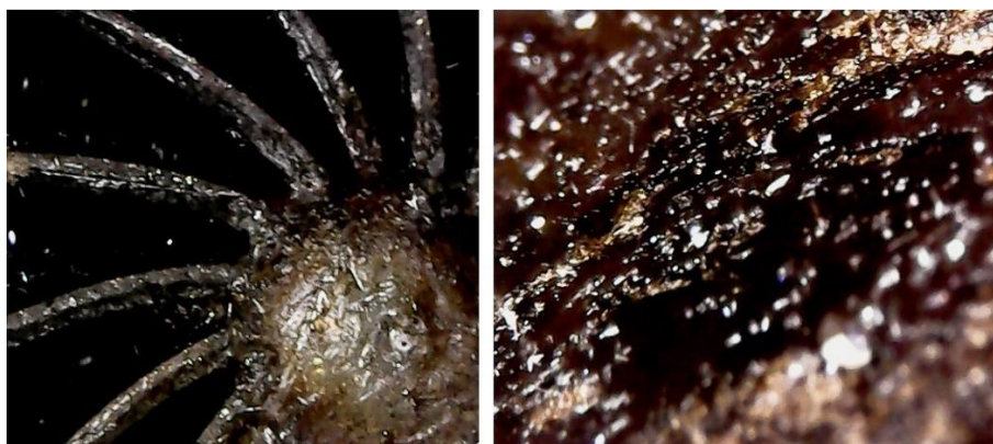
Fig. 5.10. Îmbătrânirea depunerilor ureei în zona tronsonului de injecție, detalii.
