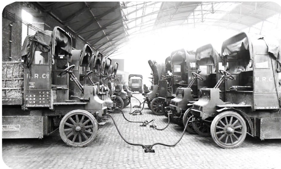
Fig. 1. Autovehicule cu propulsie electrică surprinse în timpul procesului de încărcare, în Londra, EN, Regatul Unit, în anul 1917 [002].
