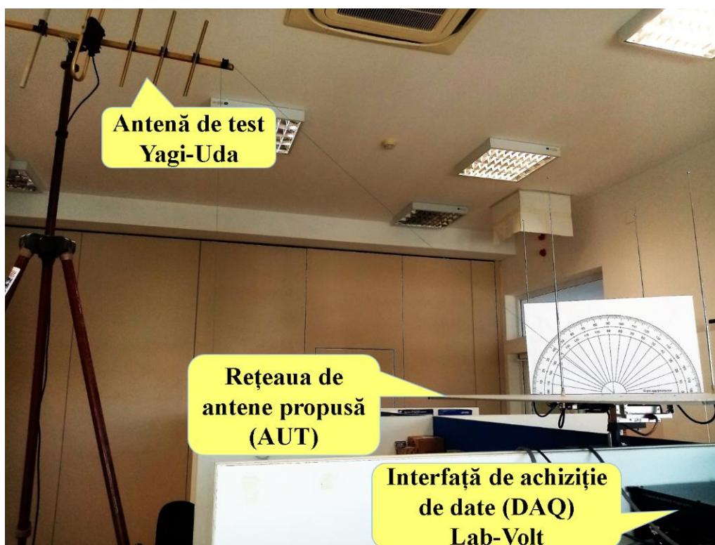
Figura IV-6 Configurația de laborator pentru măsurarea diagramelor de radiație ale rețelei de antene propuse. Raportorul a fost folosit pentru fixarea antenei Yagi-Uda la aproximativ 42^\circ elevație față de centrul rețelei.
