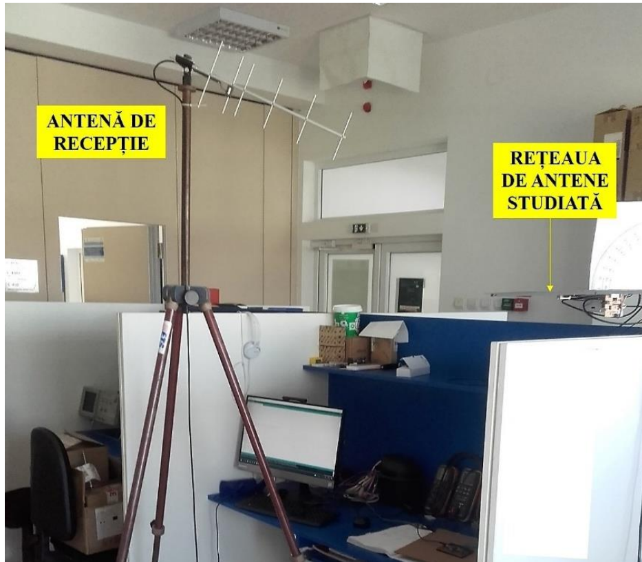
Figura III-10 Testarea diverselor poziții ale antenei de recepție Yagi-Uda relative la rețeaua de antene testată, în cadrul măsurătorilor caracteristicilor de directivitate.
