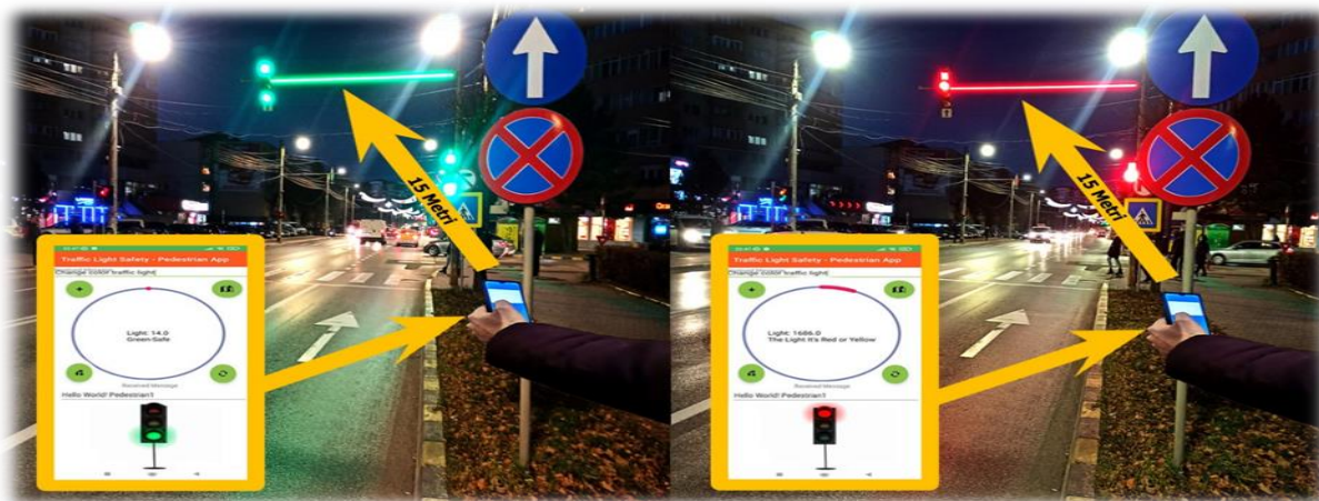
Figura 4.8. - Expunerea aplicației într-un mediu dinamic, efectuând măsurători pe o distanță de maxim 15 m.
