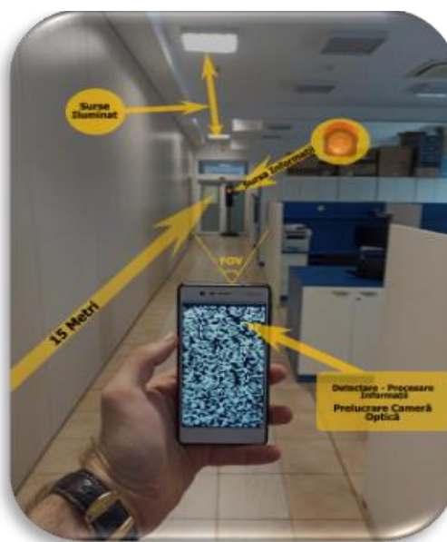
Figura 4.5. Proces de detectare într-un scenariu interior cu surse de lumină perturbatoare la o distanță de 15m.
