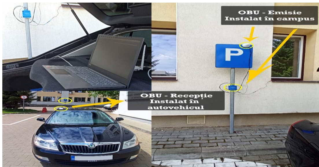
Figura 5.8. - Configurație sistem și instalare exterioară (emisie).
