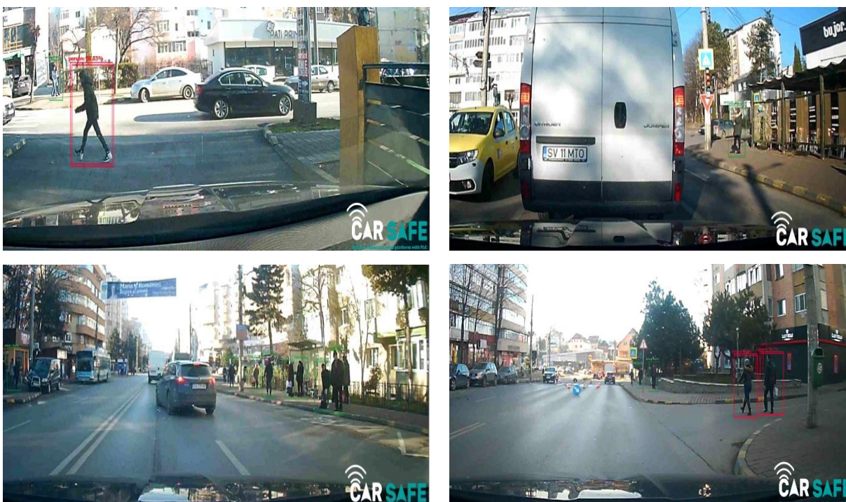
Figura 5.14. - Detecția pietonilor și mișcările predictibile. Identificarile conturate roșu reprezintă o intenție periculoasă, iar cele verzi denotă o locație sau o poziție/locație sigură.
