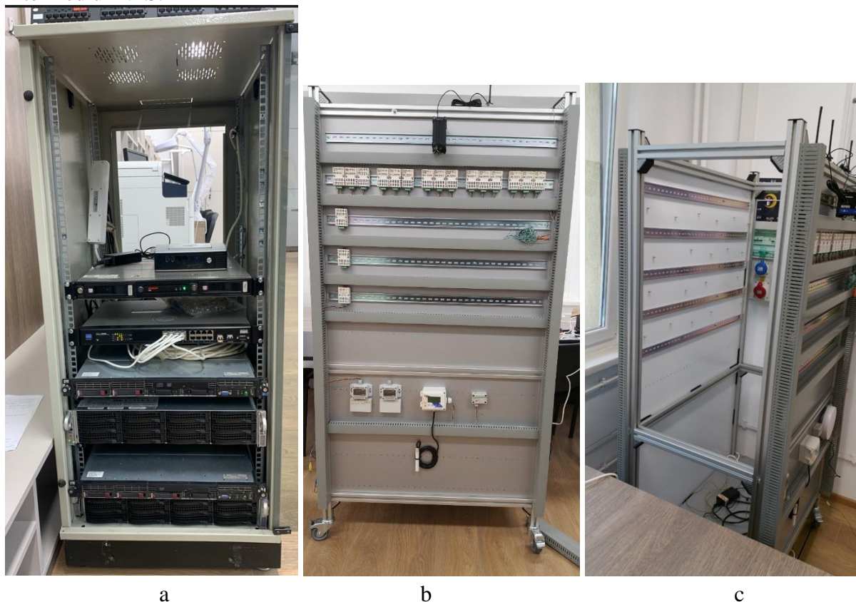
Figura 2-31 Implementarea serverelor și mașini virtuale (VMware, Hyper-V), exemplu de servere cu redundanță (HP DL360 G7), router virtual PF Sense(Beckhoff server) și switch CISCO-24 porturi
