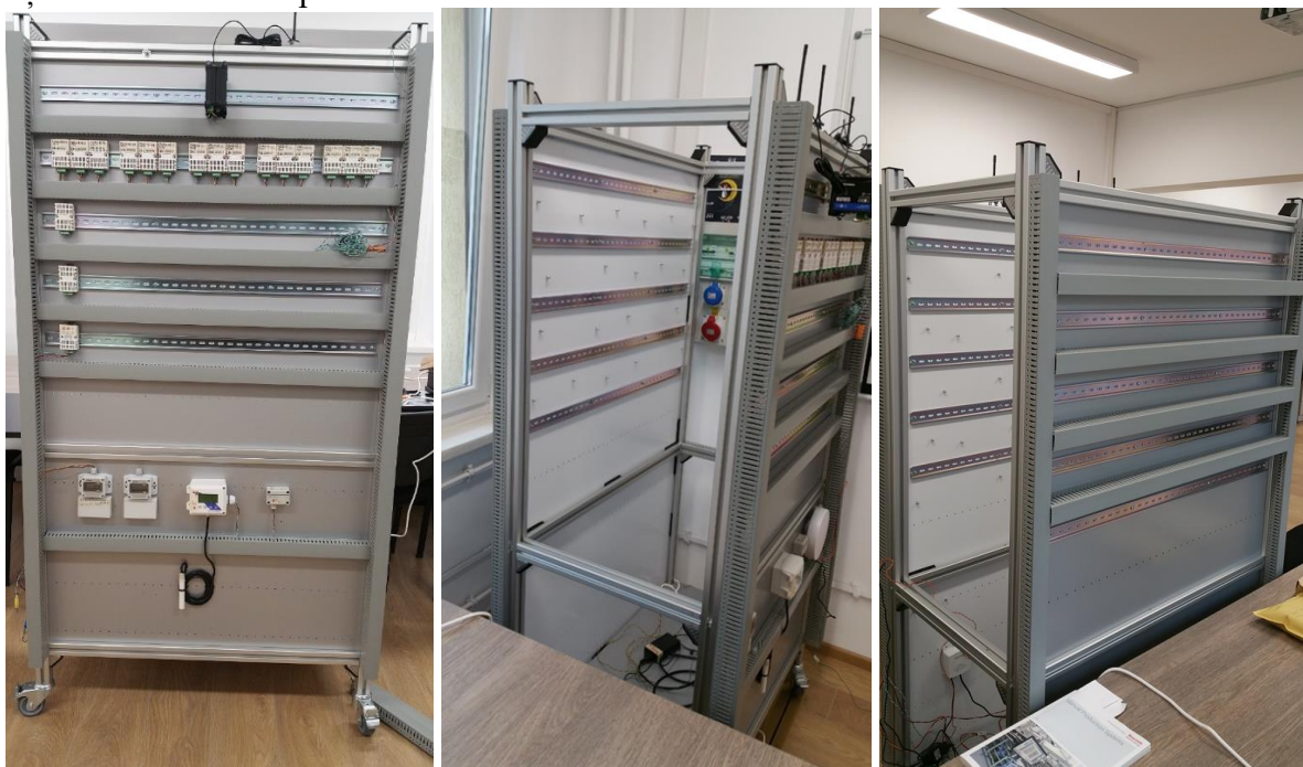
Figura 2-10. Vedere de ansamblu a Bancului de Test. Maxim 512 senzori de dimensiuni moderate, montați pe cele 4 fețe ale bancului de test [114]
