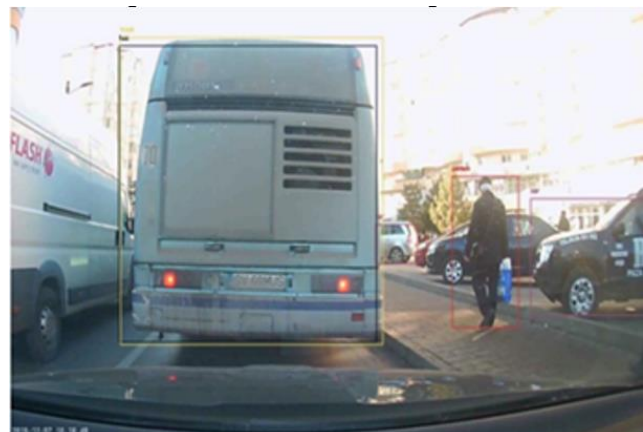
Figura 25 – Test experimental privind reunoașterea automată a claselor de obiecte folosind tehnologii standard recunoaștere vizuală computerizată pentru analiza fluxului video.
