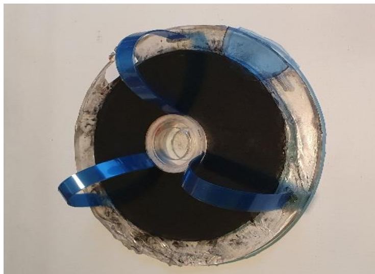
Fig. 6.10. Stand experimental cu pilitură de grafit
