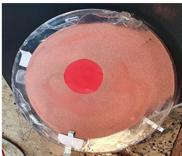
Fig. 6.12. Stand experimental cu pilitură de cupru
