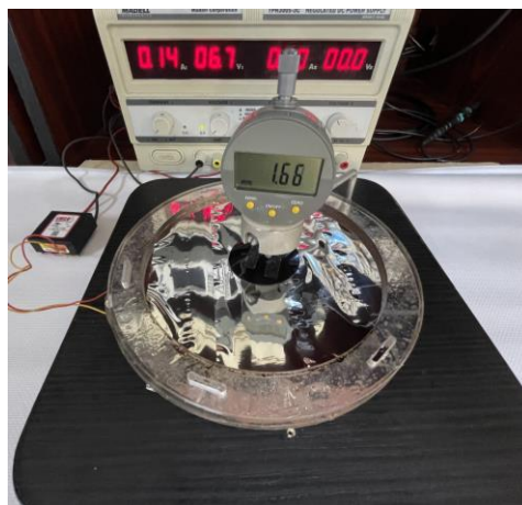
Fig. 6.14. Stand experimental de testare a deformării polimerului cu folia din Cupru și folia din Aluminiu la o tensiune 6000 V.
