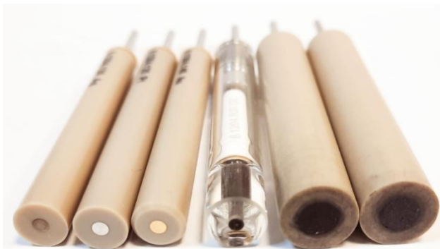
Figura 3.1. Electrozii utilizați pentru măsurare: electrodul de Ag, Pt, Au, sticlă, ZnO și TiO 2
