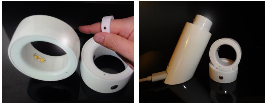
Figura 5.1. Inelele Ring Zero folosite în cadrul experimentului (imaginea din stânga), respectiv dispozitivul de încărcare (imaginea din dreapta).
