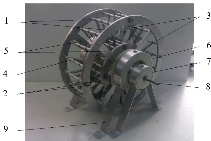
Fig. 2.29 Stand experimental. Prototip motor cu nitinol (reprodus după [141])
