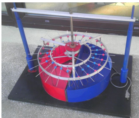
Fig. 2.28 Motor termic cu rotor excentric cu Ni-Ti realizat în cadrul Centrului EMAD [140]
