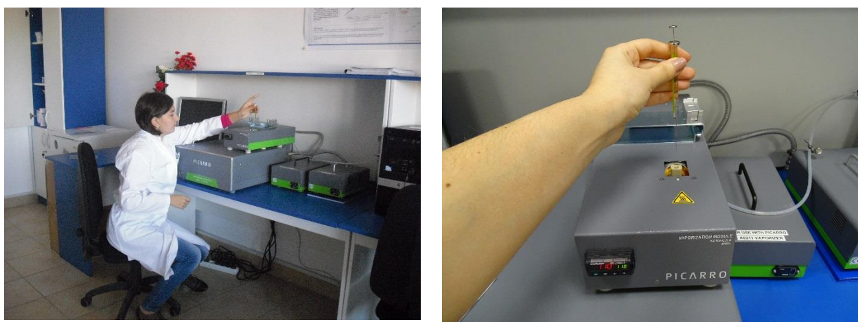
Fig. 4. Componenta spectrometrului cu laser Picarro L2130i și injectarea manuală a probelor cu ajutorul seringii de tip SGC Analytical Science (Sursa fotografiilor: Viorica Nagavciuc)
