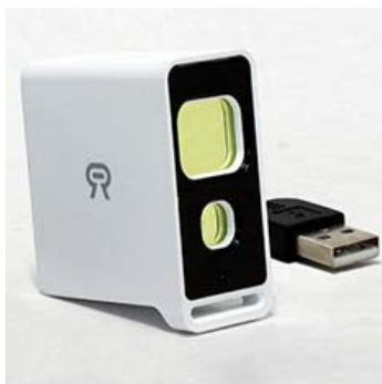
Figura 1.3. Camera cu obiectiv pentru recunoaștere după iris (sus) și webcam (jos) Panasonic BM-ET100US
