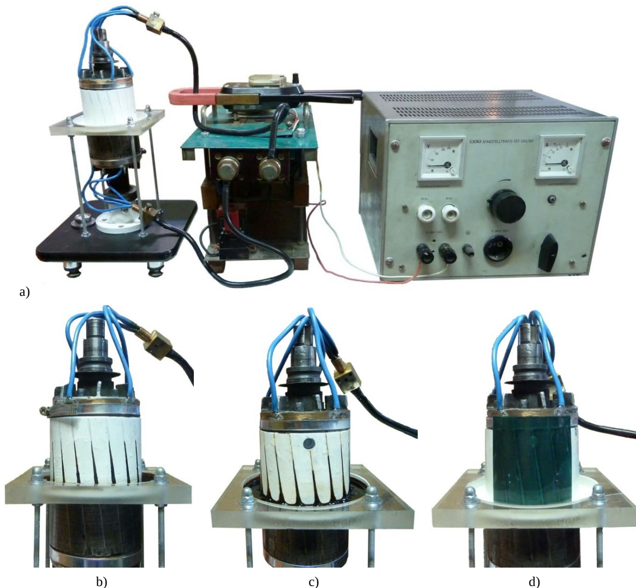
Fig. 3.14 Instalație pentru defectoscopia coliviei rotorice: a) model experimental; b) detaliu rotor fără defect; c) rotor cu defect simulat diagnosticat cu instalația cu ferrofluid; d) rotor cu defect simulat diagnosticat prin metoda cu indicator de flux magnetic.
