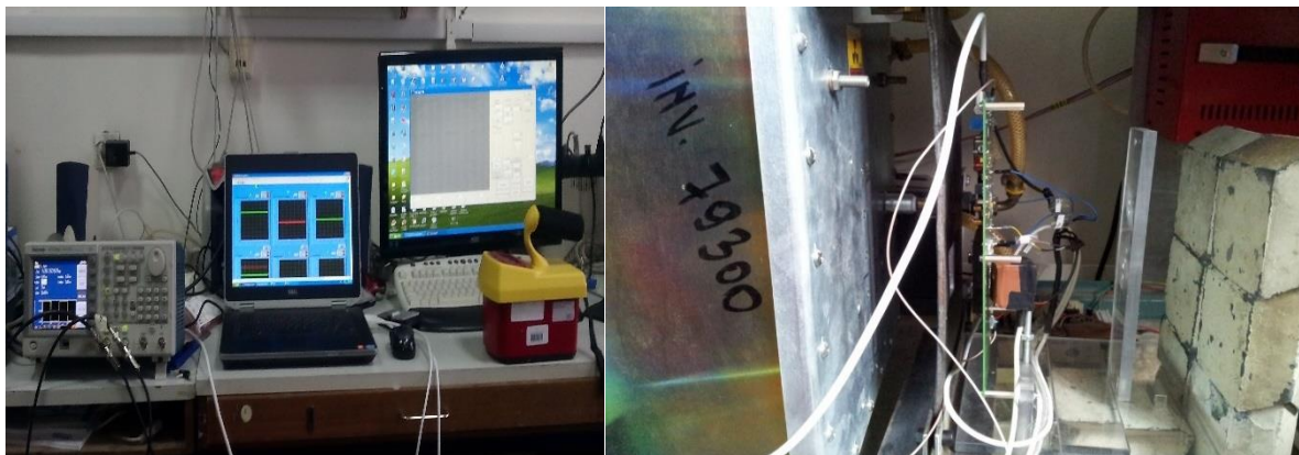
Figura 3-3 Standul de teste MAROC3 instalat în generatorul de raze X.
