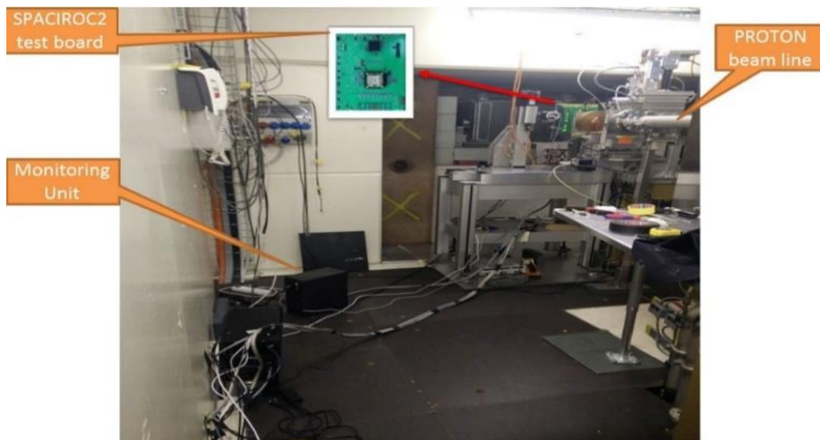
Figura 4-3 Standul de test pentru SPACIROC2 instalat la PIF (partea stângă) și linia de fascicul din apropiere (partea dreaptă).
