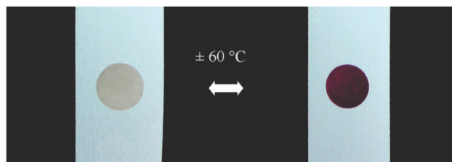
Figura 2.2 Schimbarea culorii compusului în stare lichidă [\text{Fe}(\text{C}_n\text{-trz})_3](4\text{-MeC}_6\text{H}_4\text{SO}_3)_2 \cdot \text{H}_2\text{O} [101].
